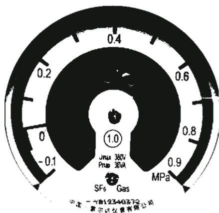
图6 K-means 二值化结果
