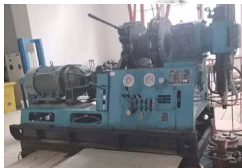
图2 XY-4型岩心钻机实物图
