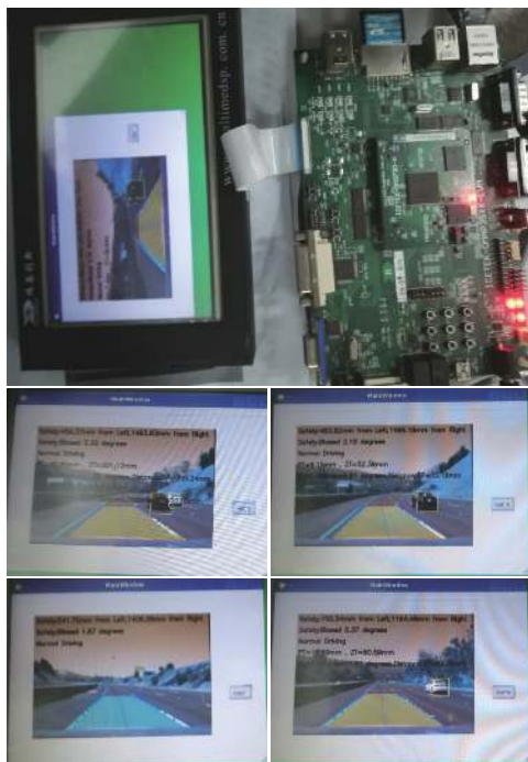
图 16 本文算法在 DM3730 平台上的运行结果图
