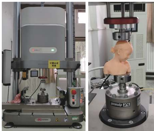
(a) 使用英斯特朗试验机进行压缩测试
