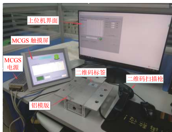
图 11 铝模板分拣系统装置实物图
