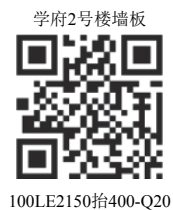
图2 铝模板的二维码标签
