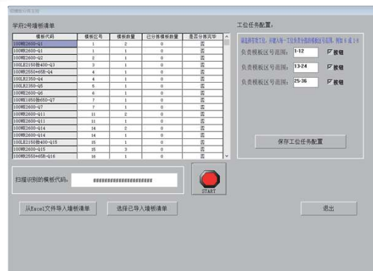
图 9 铝模板分拣系统的上位机界面
