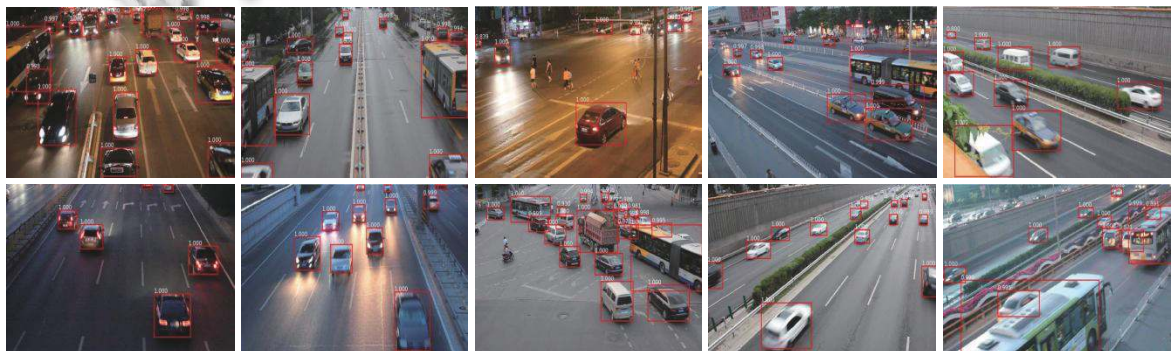
图 3 本文提出的车辆检测算法在 UA-DETRAC 测试集上的结果 (红色框标出)
