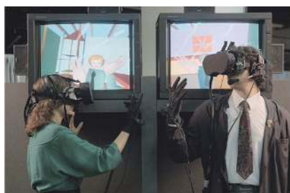
图3 EyePhone VR头盔和数据手套
