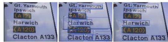
图5 使用非极大值抑制算法后文本检测结果
