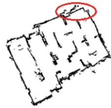
图 1 积累误差导致的地图不准确示意图
