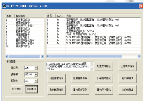
图10 引导程序进入测试模式
