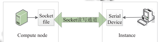
图 2 qga 通信原理图
