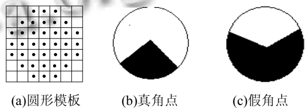
图 2 7 \times 7 圆形模板及利用 USAN 的角点判别
