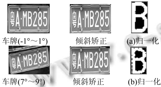
图 9 不同倾斜角度车牌识别过程
