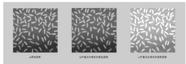
a)原始图像 b)中值法处理后的椒盐图像 c)中值法处理后的高斯噪声图像
