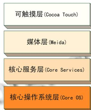
图 1 iOS 的系统架构
