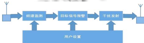
图3 无线电监测装置原理
