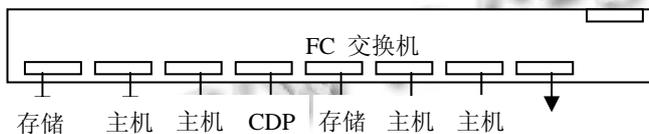
图 3 FC 交换机端口分配示意图
