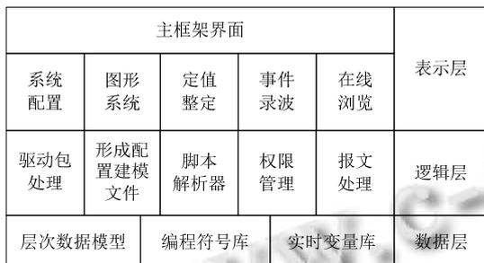
图 6 装置配套工具软件架构
