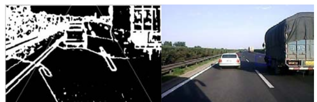
图 4 SUSAN 边缘检测及检测结果
