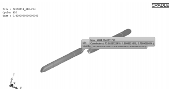
图 10 列车运行 0.42s 时最大压力值(鼻尖处)分布图
