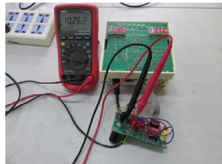
图 8 实验室数据采集系统校正测量
