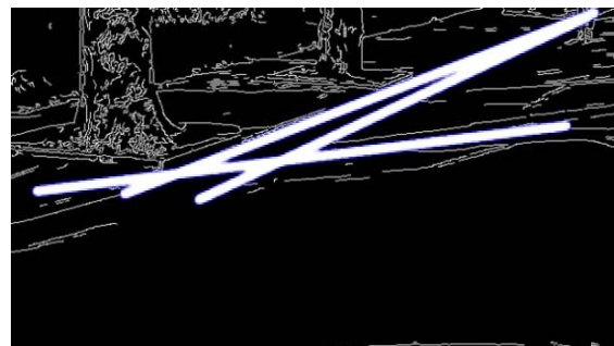
图 9 Hough 检测并筛选后的直线
