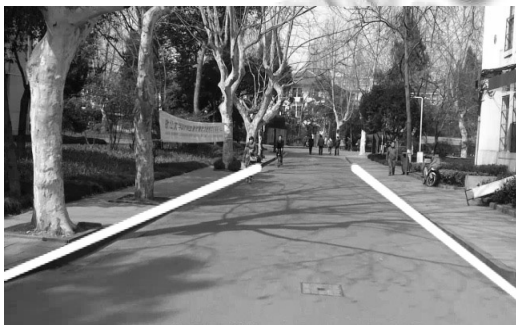
图 11 采用 MERD 算法进行道路边缘检测结果
