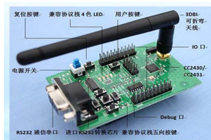
图 7 定期设备样机及其构造
