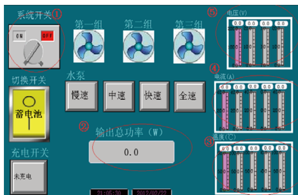
图8 上位机监控软件界面
