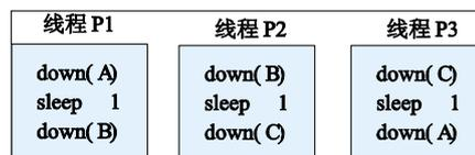
图 7 三个线程产生的信号量死锁
