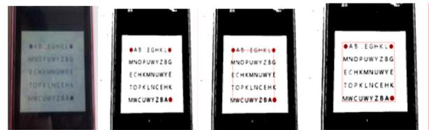
(a)原图像 (b)定位三个实心圆 (c)圆心定位 (d)字符条码区域定位
