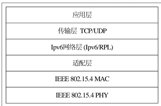
图 4 6LoWPAN 协议栈参考模型
