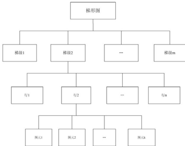
图 1 梯形图结构图
