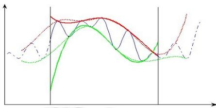
图 4 无延拓包络与实际包络的边界对比
