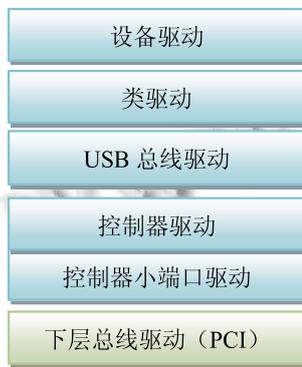
图 1 USB 设备驱动的层级结构
