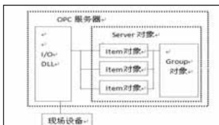
图 2 OPC 服务器整体结构
