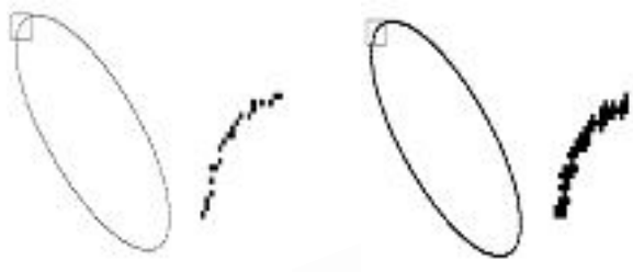
图5 (a) 原算法旋转后 (b) 4邻域填充后的图
