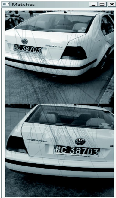
图 5 用 SIFT 算法的出前后两帧画面的匹配
