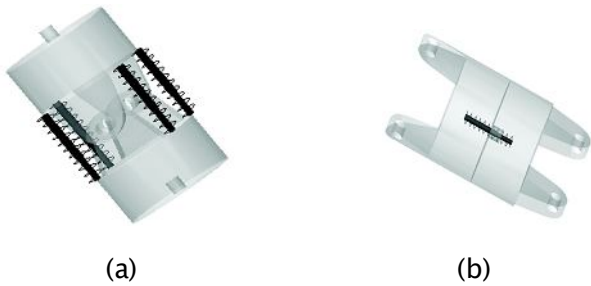
图 1 P-R 模块连接、关节处记忆合金弹簧
