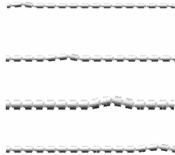
图 6 蛇形机器人行波运动流程图
