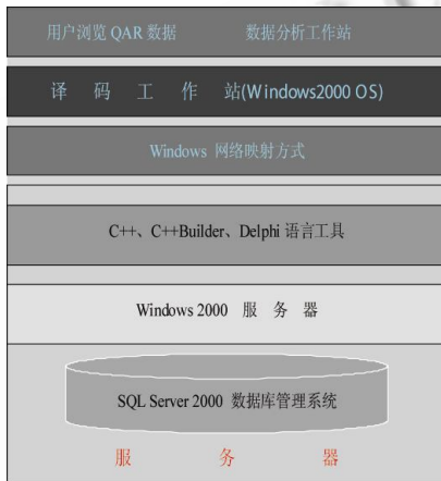
图 2 飞行数据译码分析系统软件架构图
