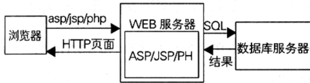
图 5 三层结构 B/S 模式工作原理
