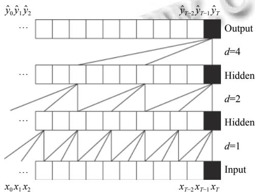
图 6 膨胀卷积结构
