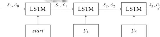
图 5 解码器结构
