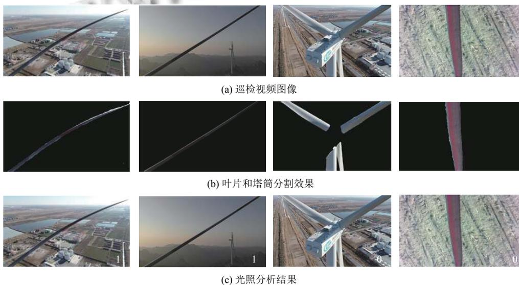
图 4 基于图像的光照分析结果
