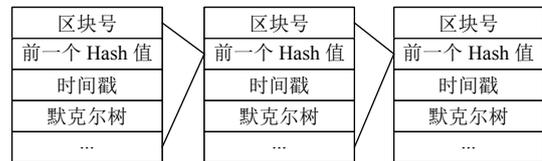
图 1 区块链数据结构示意图
