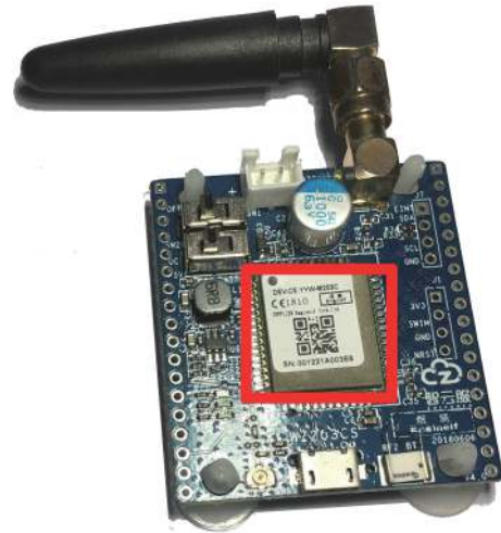
图 5 WZ-203CS 开发板实物图
