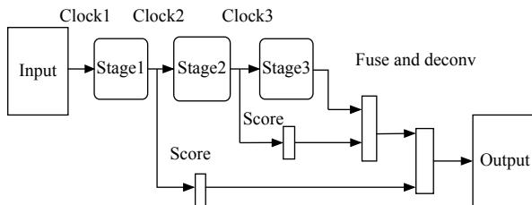
图1 Clockwork FCN 框架
