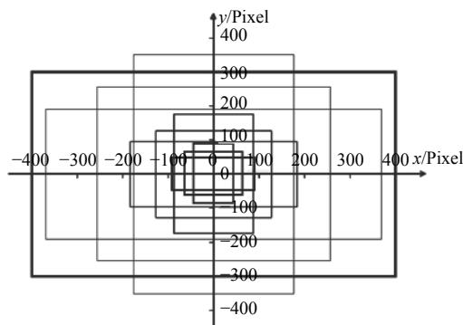
图5 特征图中心点对应的 anchor
