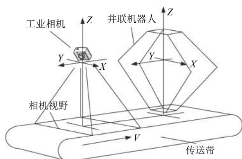
图 1 机器人分拣系统硬件构成
