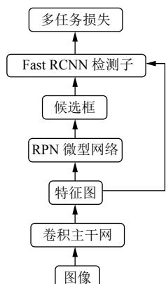
图 3 Faster RCNN 算法框架
