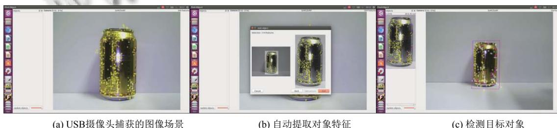
图 1 find\_object\_2d 包目标检测功能的实现过程
