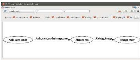
图 6 目标检测节点以及网络连接方式
