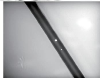
图1 含有缺陷的焊缝图像
