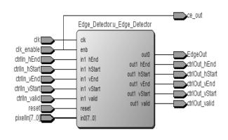
图 10 边缘检测算法的 RTL 图
