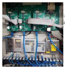
图 5 CAN 硬件电路实物图
