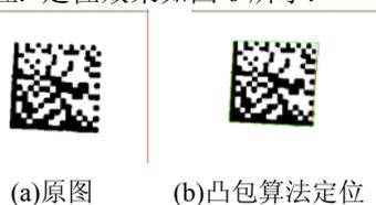
图 6 凸包算法定位效果
