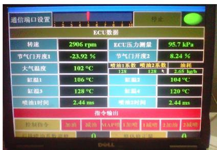
图 5 ECU 控制面板
