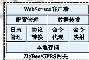
图 5 ZigBee/GPRS 无线网关的软件架构
