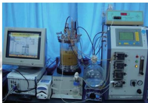
图 5 L-乳酸测控系统实物图
